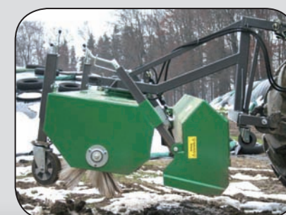
Kompaktkehrmaschine: Hydraulische Schmutzbehälterleerung
