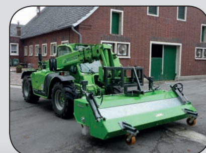
FKM an Teleskoplader Merlo
