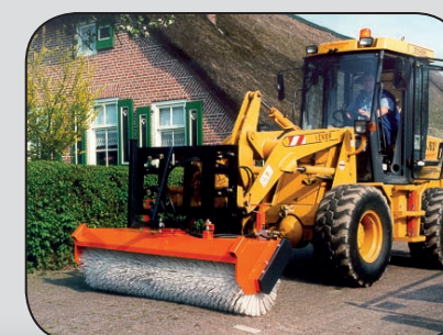
Frontkehrmaschine an Veneri Radlader
