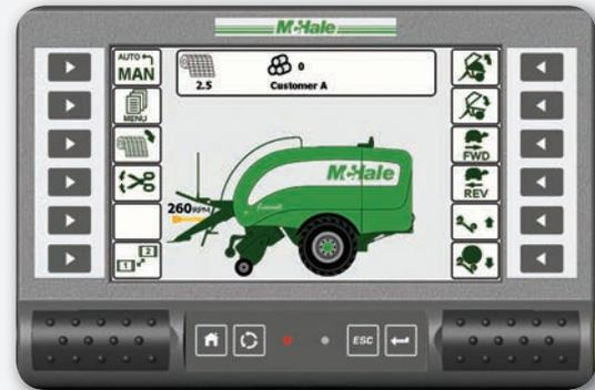
La McHale Fusion Vario è una imballatrice/fasciatrice combinata, completamente automatica. Il terminale di controllo in cabina iTouch, è dotato di chiari indicatori di funzionamento della macchina, sul suo grande schermo touch screen.
