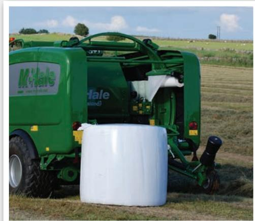
Quando si scarica la balla, il rullo posteriore di fasciatura si muove verso il basso e la Fusion Vario posiziona gentilmente la balla fasciata sul terreno.
