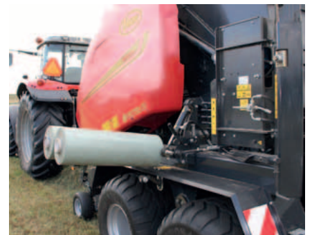
Die Ersatzrollen werden hydraulisch herausgeschwenkt.
