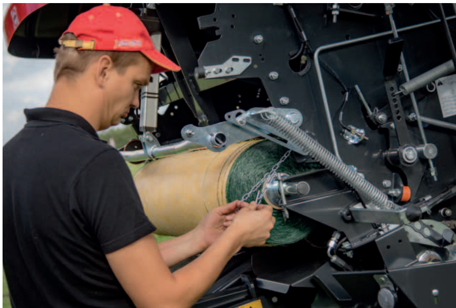
Die sehr geringe Ladehöhe macht den Wechsel der Netzrolle sehr einfach und schnell.
