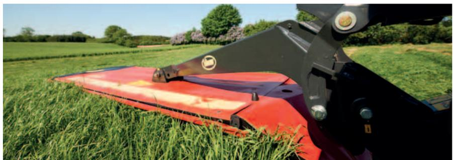
Die Mittenaufhängung ermöglicht schnelle und präzise Bodenpassung.
