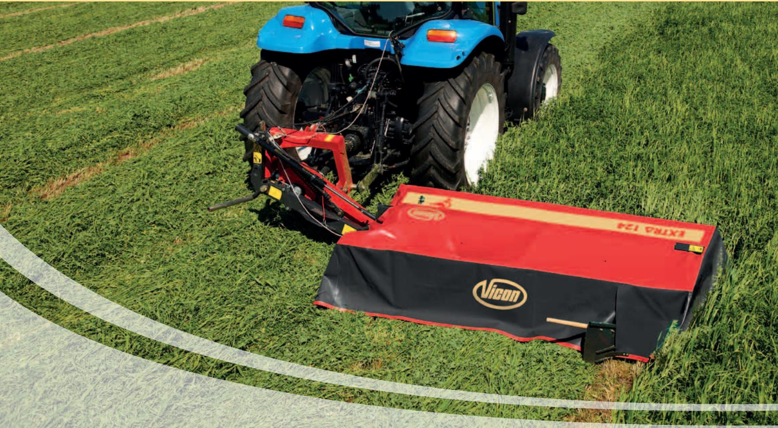
Die EXTRA100 Baureihe ist mit dem geschweißten Mähbalken ausgestattet. Dieser Mähbalken besteht durch seine Laufruhe und seiner sehr guten Arbeitsqualität. Er besteht aus zwei ineinander gelegten C-Profilen die miteinander verschweißt werden.
