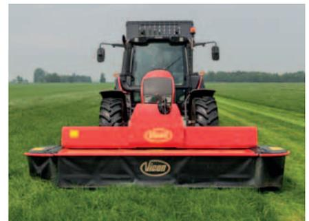
Der Einsatz mit reduzierter Drehzahl ist möglich beim EXTRA 332XF. Durch Wechsel der Riemenscheiben ist 750 U/min möglich.
