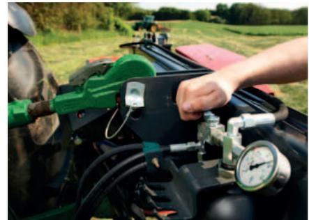
Hydropneumatische Bodendruckentlastung und perfekte Boden Anpassung (EXTRA 432H).
