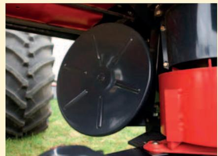
Die Maschinen können mit zwei Schwadscheiben ausgestattet werden. Sie ermöglichen Schwadbreiten von 2,20-2,40 m.
