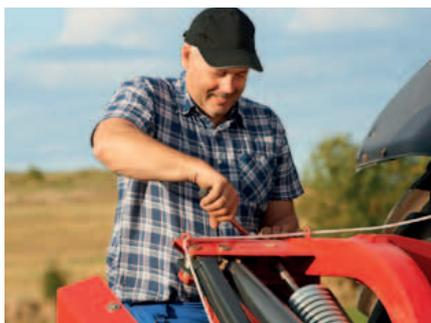
Einfach einstellbare Entlastungsfedern.
