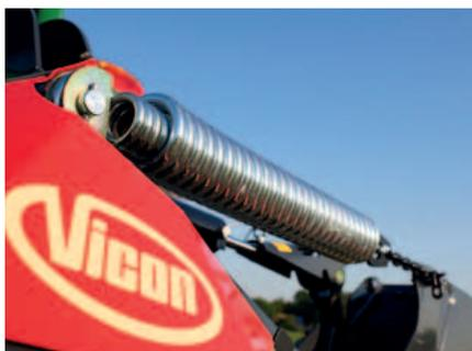
Große Entlastungsfedern garantieren immer eine optimale Bodendruckentlastung mit perfekter Bodenpassung.
