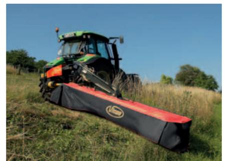
Die Boden Anpassung kann in einem Winkel von 15° nach oben bzw. unten erfolgen.
