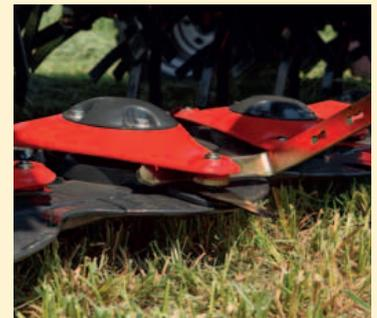
gehört auch eine neue Montagelinie für Mähbalken. Mähbalken sind im Grunde Hochgeschwindigkeitsgetriebe, bei denen es extrem auf Präzision ankommt. Deshalb werden sie, um Toleranzschwankungen zu vermeiden, vor der Endmontage auf einer CNC-Drehmaschine bearbeitet. Jeder Mähbalken durchläuft sorgfältige Tests, und für jeden einzelnen gibt es einen Testbericht, mit dem sich die komplette Produktionshistorie zurückverfolgen lässt, falls nötig.
