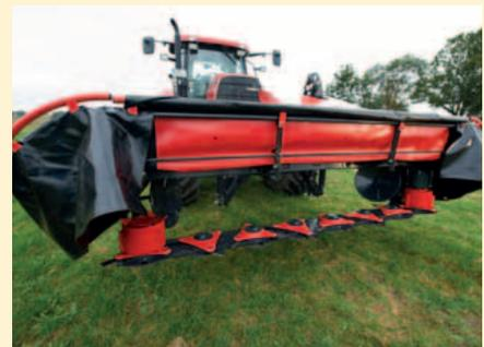
Optimaler Zugang zum Mähbalken durch klappbaren Front- und Seitenschutz.
