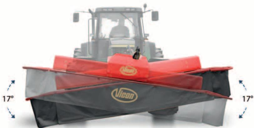
Die Mäheinheit bewegt sich unabhängig vom Fronthubwerk des Schleppers, dadurch kann die bestmögliche Boden Anpassung des Mähwerkes erzielt werden.
