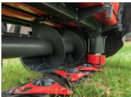
Aktiv angetriebene Schwadzusammenführung für ein perfektes Schwad.
