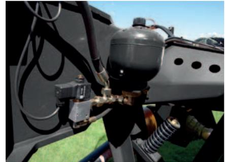
Hydropneumatische Bodendruckentlastung (EXTRA 440H).
