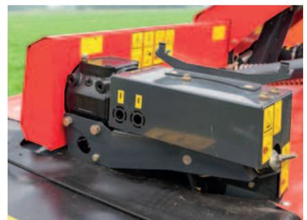
Die Schnecke wird über ein kleines Getriebe angetrieben. Der zusätzliche Leistungsbedarf beträgt nur 5 PS.
