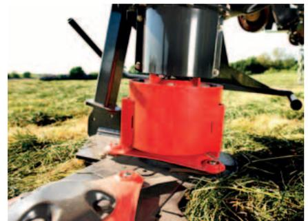
Direktantrieb vom Getriebe zur ersten Scheibe für effiziente Kraftübertragung.
