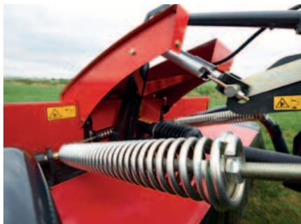
Zwei Entlastungsfedern sorgen für perfekte Boden Anpassung.
