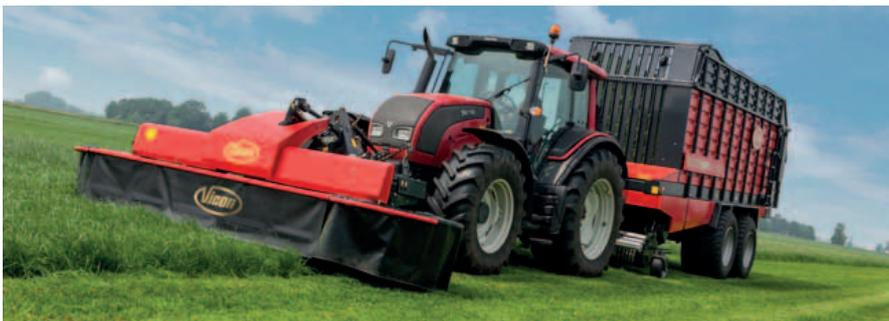
EXTRA 332XF ist perfekte Mähwerk in Kombination mit einem normalen Heckmähwerk.
