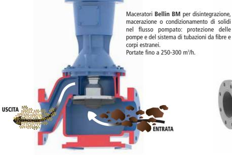
Maceratori **Bellin BM Pipeline** per settore depurazione acque ed industria con corpo in ghisa compatto, lame taglio auto-compensanti, tenuta meccanica autolubrificata in bagno d'olio, fondo per deposito oggetti pesanti e sportelli per pulizia.
