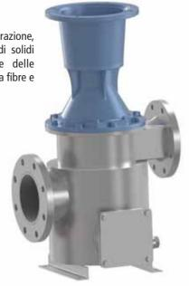
Bio-Macerator Bellin serie BMF - esecuzione per applicazioni in impianti di biogas: ampio corpo in acciaio zincato (inox su richiesta), fondo per deposito corpi grossolani e pesanti con apposita apertura per facile ispezione e pulizia.
