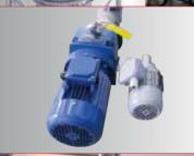
VARIATORE DI VELOCITÀ CON SERVOCOMANDO ELETTRICO
