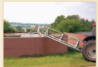
Il prolungamento tipo **OCELOT** trasforma il miscelatore con presa di forza cardanica tipo **TIFONE** in un miscelatore ottimale e vantaggioso per omogeneizzare il liquame delle vasche aperte fino a 2,40m.
