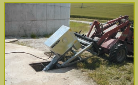
Einsatzmöglichkeit für Front-/Hoflader mit Schnellwechseltechnik. Für geschlossene Gruben und offene Behälter bis 3 m Außenhöhe.
