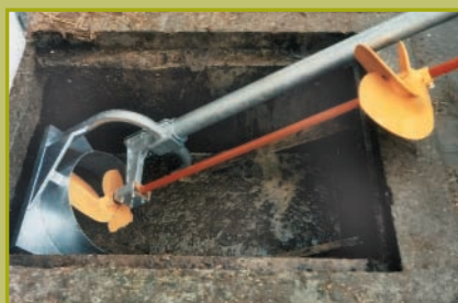
Bei Ringkanal- und Slalomsystemen empfehlen wir ab 1,80 m Kanaltiefe einen Doppelrahmenmixer mit höhenverstellbarem Schwimmschichtpropeller. Die Güllelagerung in tiefen Kanälen (ab 1,80 m) spart Außen-Güllebehälter.
