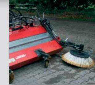
Hydraulisch angetriebener Seitenbesen (70 cm)
