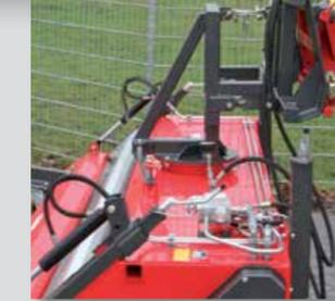
Ventilblock mit integrierter Druckvorhaltetechnik und Mengenregelventil
