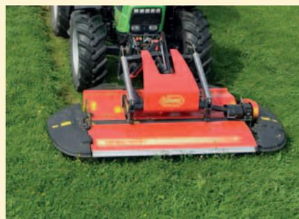
Darüber hinaus ermöglicht die innovative Aufhängung eine Queranpassung von 24° und gewährleistet somit eine hervorragende Anpassung des Gerätes an unebene Bodenkonturen sowie höhere Arbeitsgeschwindigkeiten.
