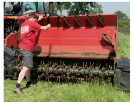
Das gesamte Heck des Mähers kann für einfachen Zugang zum Aufbereiter angehoben werden. Der Aufbereiterrotor kann für das Mähen ohne Aufbereitung sehr schnell vollständig ausgebaut werden.
