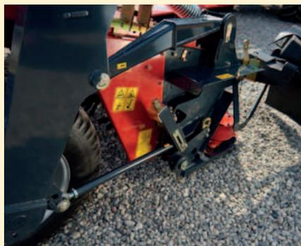
Die perfekte Mähwerksaufhängung sichert, dass sich die Mäheinheit nach oben und unten anpassen kann.
