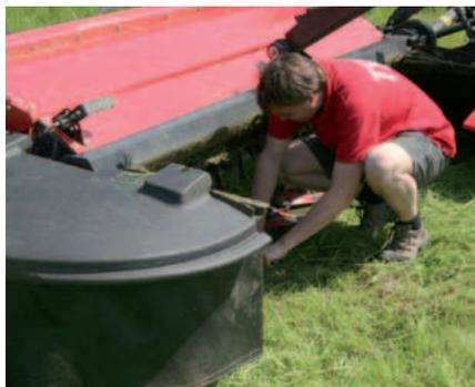
Uneingeschränkter Zugang zum Mähbalken – die gesamte Front ist für einfachen Zugang zum Mähbalken drehbar.
