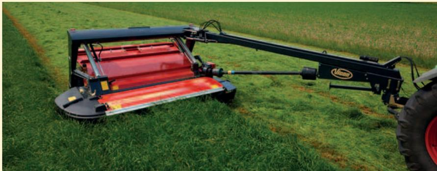
Der Hauptrahmen ist starr gebaut - hier befinden sich keine beweglichen Teile. Der Verschleiß ist auf ein Minimum reduziert.
