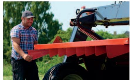
Die beiden Schwadleitbleche werden ausgebaut.
