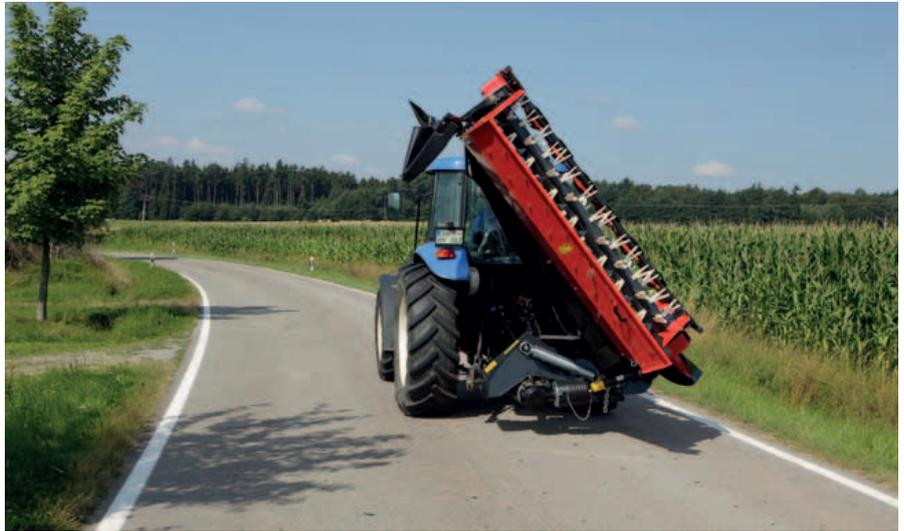
Die Modelle EXTRA 624T, 628T und 632T Farmer werden mit Hilfe eines Hydraulikzylinders in eine 125° senkrechte Transportstellung gebracht.
