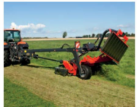
Beim ersten Durchgang wird ein normales Schwad abgelegt, wobei das Band aufrecht steht. Beim zweiten Durchgang wird das Band abgesenkt.
