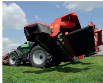
Trotz der Größe ist die EXTRA 690T-Kombination am Vorgewende sehr einfach zu handhaben. Jede Einheit kann per einfacher Bedienung eines Knopfes in der Kontrollbox hochgeklappt werden.
