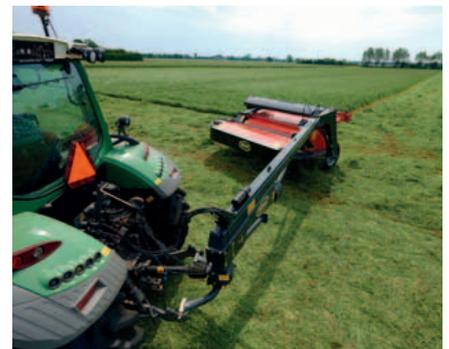
Der Schwenkdeichselkopf mit Umkehrgetriebe sorgt für optimale Wendigkeit.
