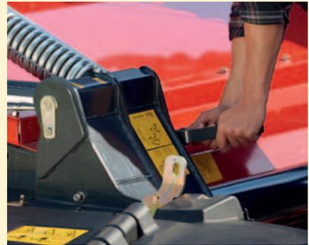
Einfache Einstellung der Aufbereitungsintensität.
