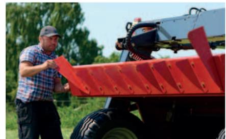
Zum Umschalten zwischen Schwadablage und Breitsstreuen werden die Streuflügel einfach um 180° nach oben gedreht.
