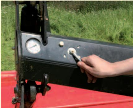
Hydraulische Aufhängung für einfache und präzise Einstellung des Bodendrucks.
