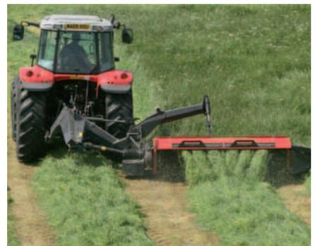
Durch Einstellung der Streuflügel kann das Mähgut in einem schmalen Schwad abgelegt werden.
