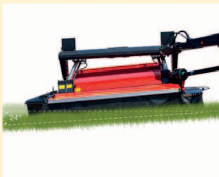
Die Entlastungsfedern garantieren auch eine einwandfreie seitliche Anpassung der kompletten Mäheinheit.
