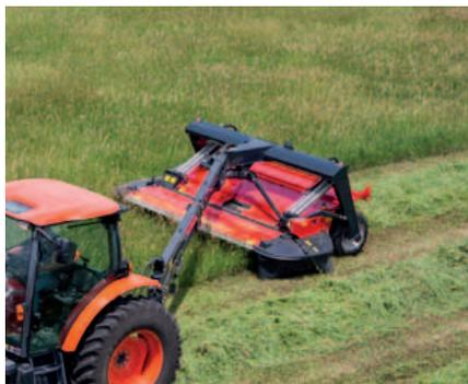
Das Mäherwerk kann rechts oder links neben dem Schlepper arbeiten,...
