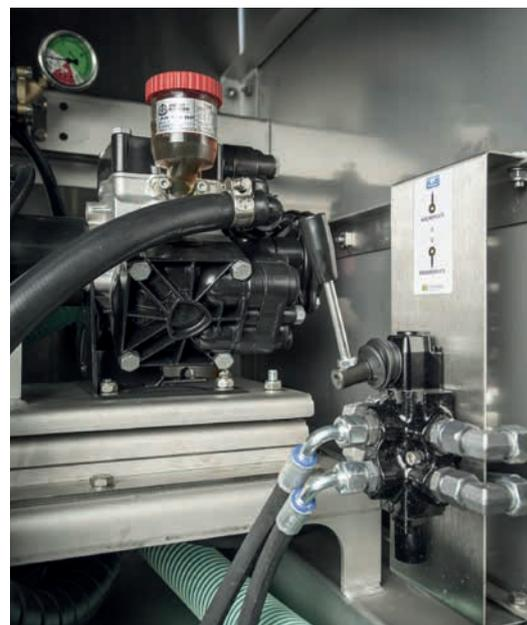
Umschaltventil zwischen Hochdruck- und Solepumpe
