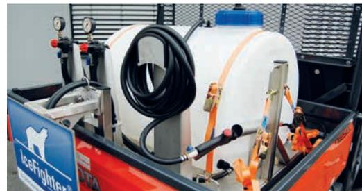
Edelstahlrahmen, PE-Tank aus Spezialkunststoff
