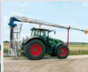
RECK-Zapfwellenmischer mit OZELOT Rahmenverlängerung für Güllehochbehälter. Hochbehälter-Zapfwellenmischer bzw. Turmmixer bis 6 m hohe Güllebehälter.
