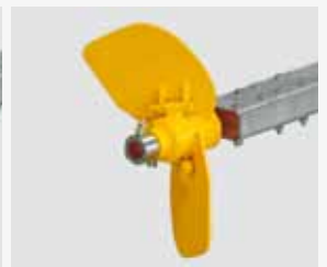
2-flügeliger Faltpropeller (für Öffnungen ab 250 mm, nur drückend erhältlich, aufgeklappt 500 mm ø)
