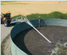
RECK-Zapfwellenmischer mit OZELOT Rahmenverlängerung für Güllehochbehälter. Hochbehälter-Zapfwellenmischer bzw. Turmmixer bis 6 m hohe Güllebehälter.
