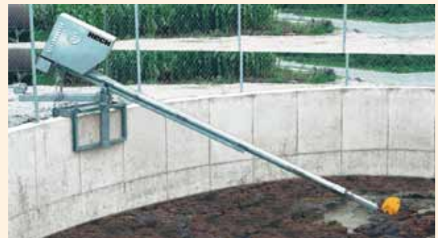
Diese Stationärbefestigung eignet sich besonders für offene Güllebehälter. Die Höhenverstellung erfolgt stufenlos. Der Schwenkbereich beträgt 360°. (Abb.: ETR-HS)
