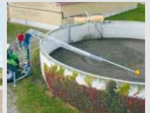
RECK-Zapfwellenmischer mit OZELOT Rahmenverlängerung für Güllehochbehälter. Hochbehälter-Zapfwellenmischer bzw. Turmmixer bis 6 m hohe Güllebehälter.
