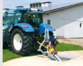
RECK-Einschwenk Zapfwellenmischer für geschlossene Güllebehälter und RECK-Zapfwellenmischer starr für offene Behälter und Lagunen
