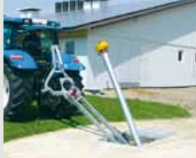
RECK-Einschwenk Zapfwellenmischer für geschlossene Güllebehälter und RECK-Zapfwellenmischer starr für offene Behälter und Lagunen
