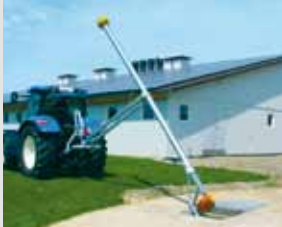
RECK-Einschwenk Zapfwellenmischer für geschlossene Güllebehälter und RECK-Zapfwellenmischer starr für offene Behälter und Lagunen
