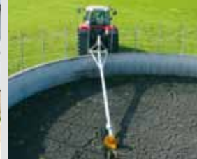
RECK-Einschwenk Zapfwellenmischer für geschlossene Güllebehälter und RECK-Zapfwellenmischer starr für offene Behälter und Lagunen
