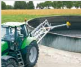
RECK-Zapfwellenmischer mit OZELOT Rahmenverlängerung für Güllehochbehälter. Hochbehälter-Zapfwellenmischer bzw. Turmmixer bis 6 m hohe Güllebehälter.
