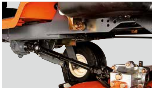
Robuster Gelenkwellenantrieb mit Schutzvorrichtung
