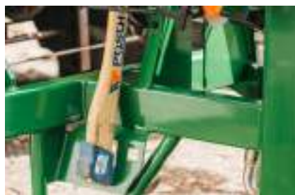
Ab HydroCombi 16: Serienmäßige Sappelhalterung in Park- bzw. Transportposition (Sappel ist nicht im Lieferumfang enthalten).
