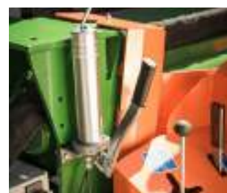
Integrierte Schmiervorrichtung über Handpumpe (optional erhältlich)
