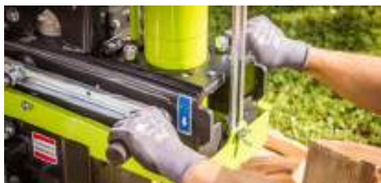
Zweihand-Schaltung für sicheres Arbeiten
