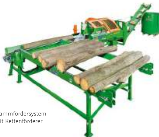
Stetige Versorgung mit dem Stammfördersystem, bestehend aus ① Querförderer und ② Längsförderer.
