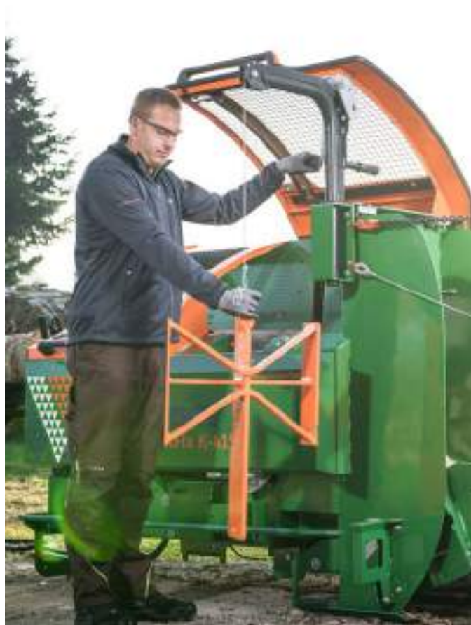
Für einen leichteren Wechsel des Spaltmessers bietet sich eine Handseilwinde optimal an. Artikel Nr. F0004317
