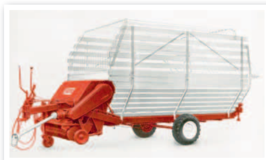
1965 folgte das weltweit erste Modell mit kurzem Kettenförderer und Schneidwerk: FAHR WE 310 L.
