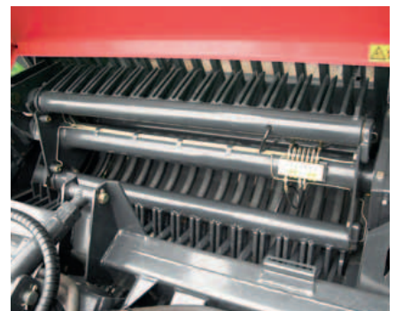
Das leistungsfähige, lenkergesteuerte Förderaggregat mit geschmiedeten Doppelfingerzinken.
