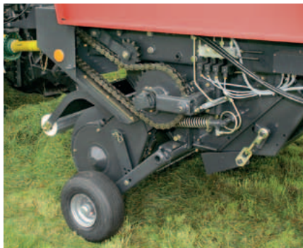
Robuster Antrieb und serienmäßige Tasträder garantieren eine sichere und schonende Aufnahme.
