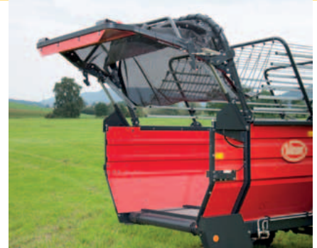
Der rasche Entladevorgang wird durch die hydraulisch betätigte, häckseldichte Heckklappe ermöglicht, die bequem vom Schlepper aus geöffnet werden kann. Den Schließvorgang überwacht ein Sensor selbstständig.
