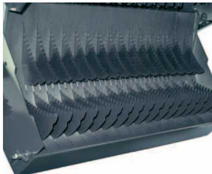
Das Schneidsystem kann komplett abgesenkt werden. Alle Messer sind mit wenigen Handgriffen ausgetauscht.
