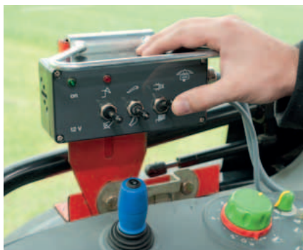
Die elektro-hydraulische Bedienung erfolgt über die PilotBox-T.
