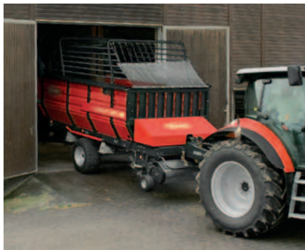
Der Dürrgutaufbau ist stufenweise mechanisch absenkbar.
