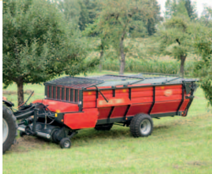
Eine hydraulische Verstellung des Dürrgutaufbaus ist optional erhältlich.
