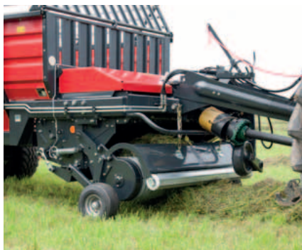
Das Prallblech sorgt für einen gleichmäßigen Futterteppich.
