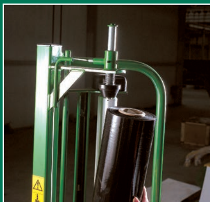
Carico della nuova bobina
