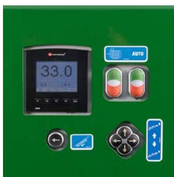
**CutControl.** Cambiamento lunghezze di taglio in pochi secondi e immissione delle tolleranze mediante touch screen
