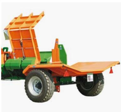
SplitMaster con **carrello longitudinale** per impiego in mobilità.
