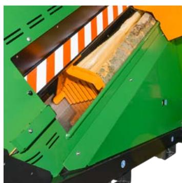
**EasyGo.** Sistema di avanzamento con misurazione ottica del ceppo per lunghezza esatta senza scarti
