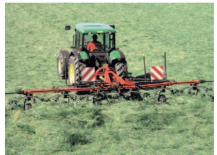
Il Fanex 683, come tutti i voltafieno ProLine, sono provvisti di una scatola di trasmissione in bagno d'olio, soluzione che consente di avere un costante lubrificazione e di essere esenti da manutenzione.
