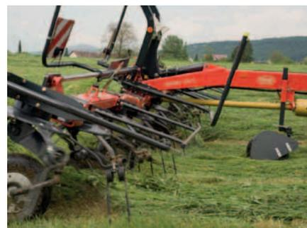
La terza ruota (opzionale) perfeziona ulteriormente le capacità di adattamento del voltafieno ai bordi. La ruota previene possibili infossature dei denti nel terreno, e può lavorare all'altezza di lavoro desiderata, regolabile senza l'utilizzo di ulteriori attrezzi.
