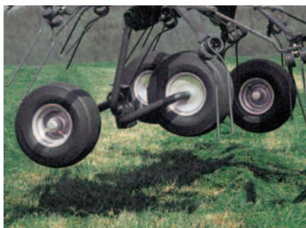
L'assale tandem (opzionale) incrementa le capacità di adattamento ai bordi del campo sui modelli Fanex 464 e Fanex 524.
