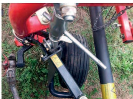
In opzione, questi voltafieno possono disporre di una terza ruota opzionale, per ottenere il miglior adattamento al terreno possibile.
