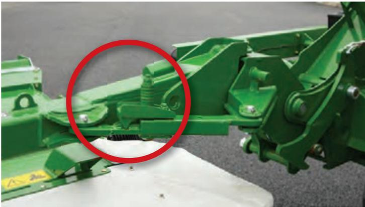
Die Pro Glide Heckmähwerke sind mit der patentierten Technologie zur Bodenadaptation ausgestattet, die dem Mähbalken erlaubt nach hinten und oben auszuweichen, falls kleinere Fremdkörper diesen treffen.
