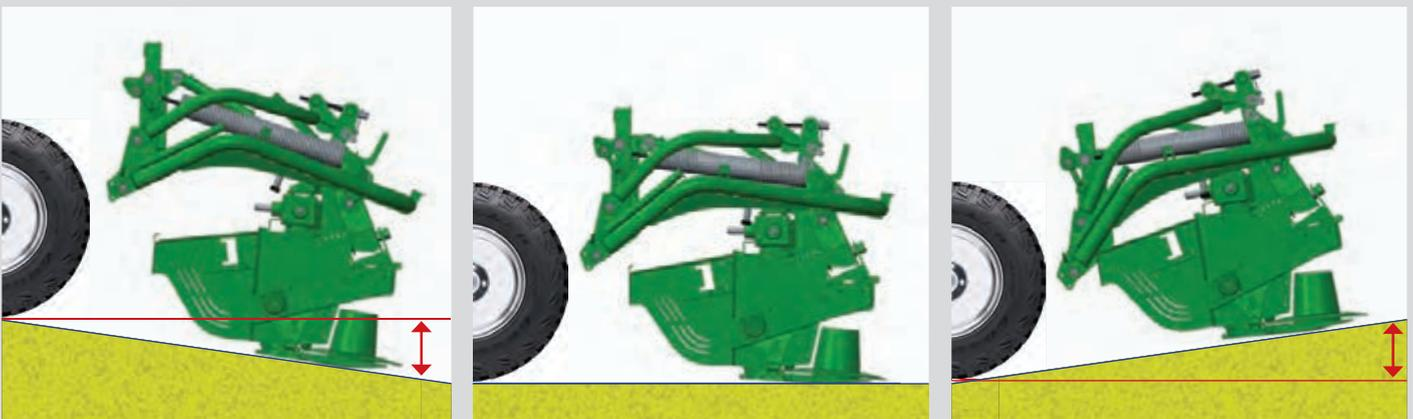
Das Pro Glide Frontmäherwerk hat seine eigene unabhängige Federentlastung, die es dem Mähwerk erlaubt, unabhängig vom Traktor und automatisch bis zu 500mm vertikal dem Bodenprofil zu folgen. Fährt man in eine Senke, passt der Mähbalken seinen Schnittwinkel automatisch nach unten an, bei einer Bodenerhebung erhöht er sich automatisch.
