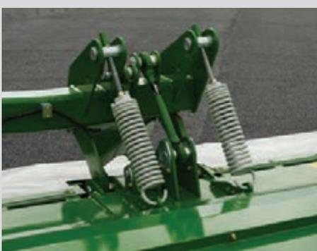
Die meisten Heckmähwerke haben einen Mittelbolzen in dem das Mähwerk nach links und rechts schwenkt, um sich dem Boden anzupassen. Die McHale Pro Glide sind anders aufgebaut, da sie mit einer patentierten Federentlastung zur 3D Boden Anpassung ausgestattet sind. Diese erlaubt dem Mähwerk:
