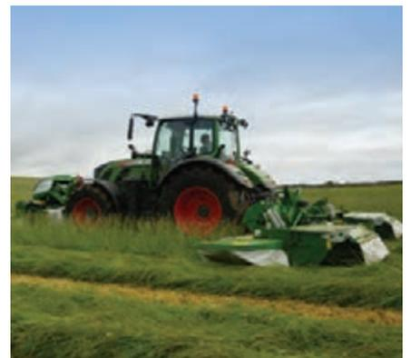
Die Pro Glide Heckentlastungsfedern reagieren unverzüglich auf Unebenheiten, was zu einem hochwertigen Schnitt auch bei hohen Fahrgeschwindigkeiten führt. Das erlaubt dem Mähwerk auch auf rauem oder welligem Untergrund leichtzügig zu mähen und optimale Ergebnisse zu erzielen.
