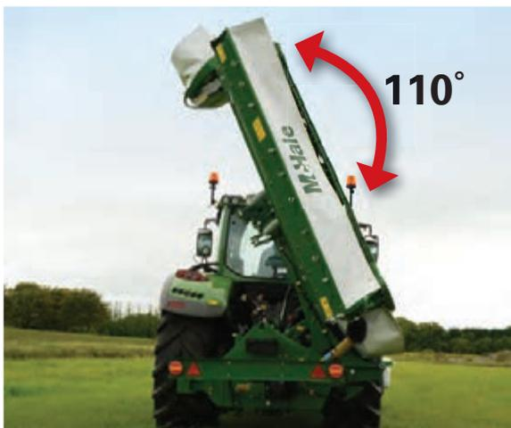
Für den Transport schwenkt das McHale Pro Glide vertikal selbständig in die Mitte hinter dem Traktor in eine sichere Transportposition. Die Transporthöhe der Maschine wurde reduziert, dadurch dass das Mähwerk über 110° schwenkt.
