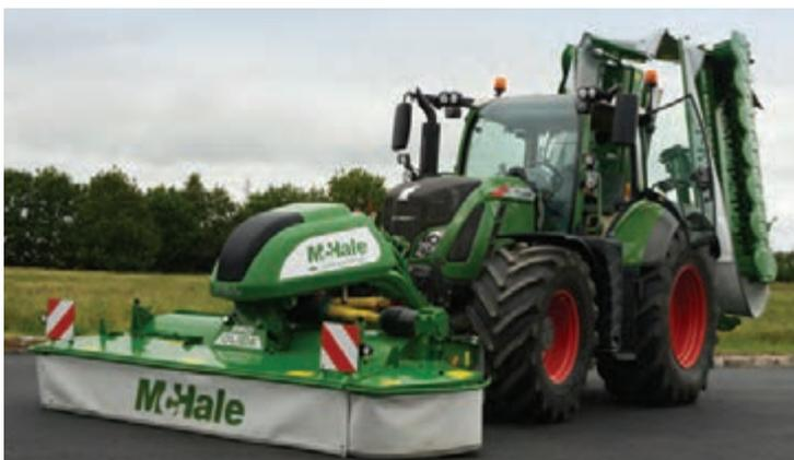
Für den Transport schwenkt das McHale Pro Glide vertikal in die Mitte hinter dem Traktor in eine sichere Transportposition.
