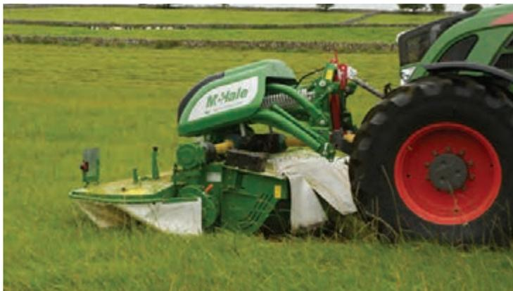
McHales Entwicklungsabteilung hat die Rahmen der Pro Glide Frontmäherwerke so konstruiert, das der Schwerpunkt so nahe wie möglich am Traktor ist, welches in einer unvergleichlichen Anpassungsfähigkeit an die Bodenverhältnisse resultiert.
