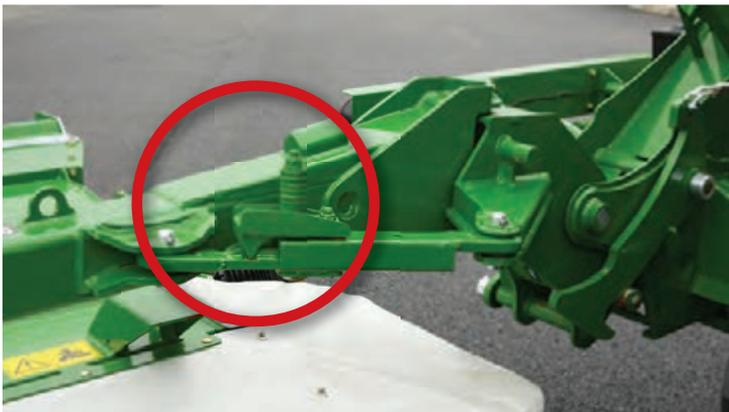
Die Pro Glide Heckentlastungsfedern reagieren unverzüglich auf Unebenheiten, was zu einem hochwertigen Schnitt auch bei hohen Fahrgeschwindigkeiten führt. Das erlaubt dem Mähwerk auch auf rauem oder welligem Untergrund leichtzügig zu mähen und optimale Ergebnisse zu erzielen.
