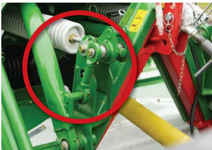
Die McHale Pro Glide Frontmäherwerke sind mit dem patentierten aktiven Federausgleich ausgestattet, der sicherstellt, dass der Mähbalken immer mit dem gleichen Bodendruck aufliegt, unabhängig von der Arbeitshöhe.
