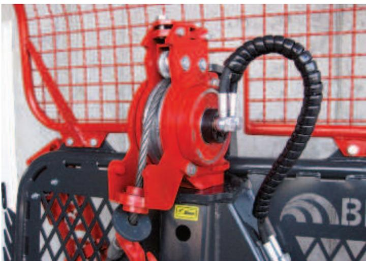
Der Seilausstoß ist eine nützliche Zusatzausrüstung im steilen Gelände, bzw. wenn das Seil nach oben gezogen werden muss.
