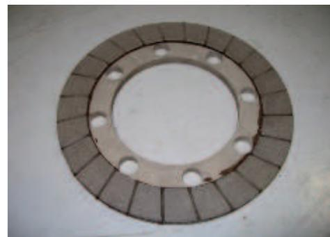
Kupplungslamellen Mit großer Auflagefläche und guter Kraftübertragung.
