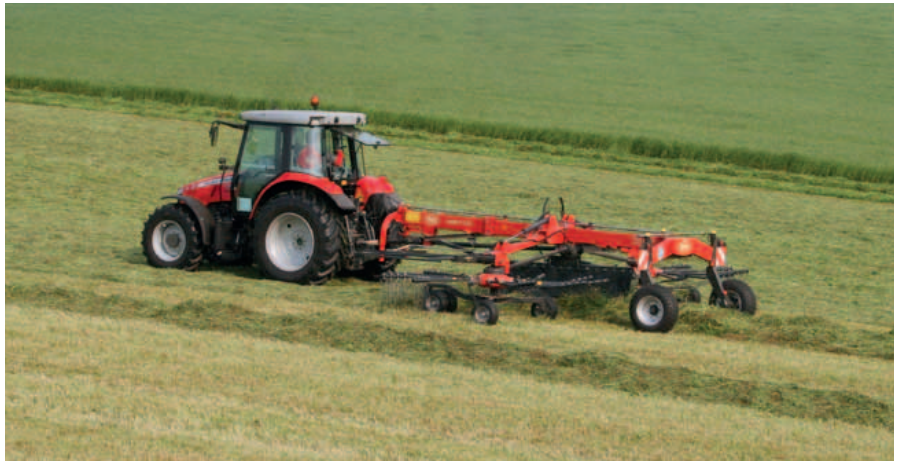
Gli andanatori ad andana centrale Andex presentano una messa in trasporto idraulica. Braccia portadenti amovibili.
