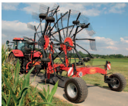
Grazie ai suoi assali speciali, l'Andex 904 Hydro ha un'altezza di trasporto inferiore a 4m, anche senza dover rimuovere le braccia portadenti.
