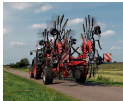
Con il suo esclusivo sistema di ripiegamento, la macchina non supera i 4m di altezza. Non è necessario rimuovere le braccia portadenti.
