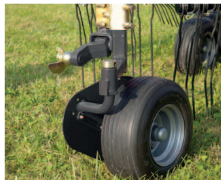
In opzione gli andanatori possono essere equipaggiati con una terza ruota per migliorare l'adattamento al terreno.
