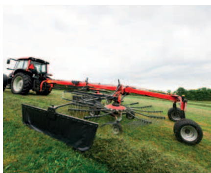
Eccellente stabilità grazie alla posizione ribassata del telaio portante.
