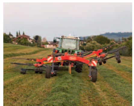
Andanatore con un solo rotore (standard sul 904, opzionale sui modelli 784 e 844).
