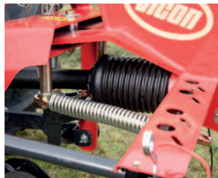
Una particolare testata d'attacco a tre punti assicura un ottimo adattamento al terreno anche nelle manovre in fondo campo o in presenza di ostacoli. In opzione sono disponibili due ammortizzatori d'oscillazione.
