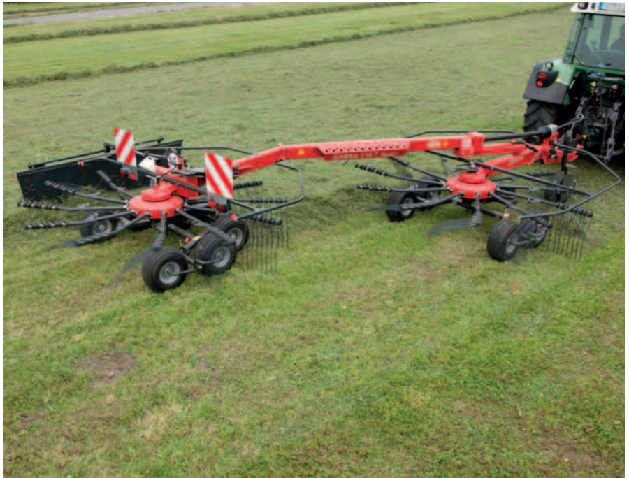
Nuovo modello 714T VARIO con larghezza di lavoro da 7,10m e sistema di spostamento laterale SideShift.
