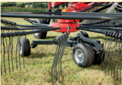
Denti curvi e semplice regolazione dell'altezza per una formazione d'andana regolare e omogenea.
