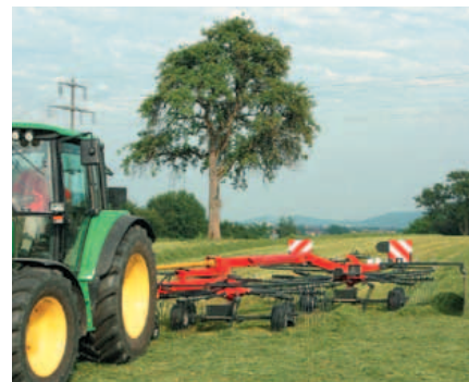
Movimento SideShift verso sinistra per evitare che la macchina calpesti l'andana.
