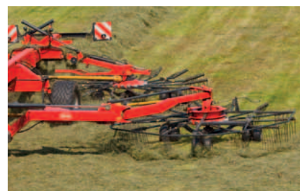
I due rotori esterni possono essere regolati individualmente per variare la larghezza di lavoro da 9,50 a 15m.
