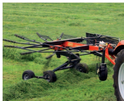
La macchina può essere sollevata fino a 50cm da terra, direttamente dal posto di guida.
