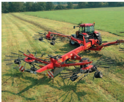
La testata d'attacco a due punti garantisce un angolo sterzante fino a 80°.
