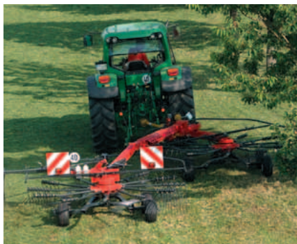
Spostamento "SideShift" del rotore verso destra - per evitare gli alberi.
