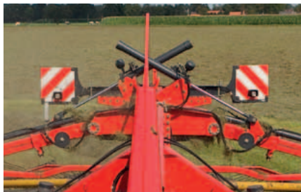
Regolazione idraulica della larghezza d'andana.
