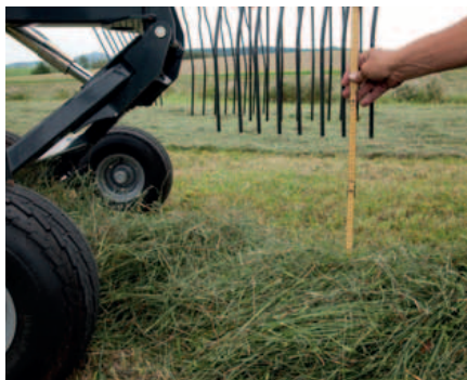
Disimpegno da terra di oltre 50cm, per oltrepassare facilmente qualsiasi tipo di andana, avviene tramite un solo distributore a semplice effetto.
