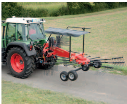
Tutti gli andanatori possono essere regolati in modo da ridurre la larghezza di trasporto, rimuovendo le braccia portadenti e posizionandole in un apposito supporto.
