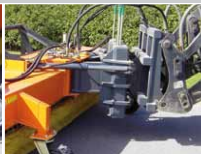
optimale Boden Anpassung durch robusten 3D-Niveaueausgleich
