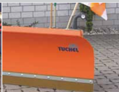
Abkantungen im seitlichen und oberen Schildbereich
