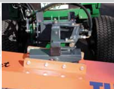
doppelter Niveausausgleich mit hydraulischer Seitenverstellung
