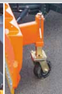
stufenlos höhenverstellbare Markenstützräder
