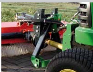
mechanischer Antrieb für Drehzahlen von 540 bis 2100 /min
