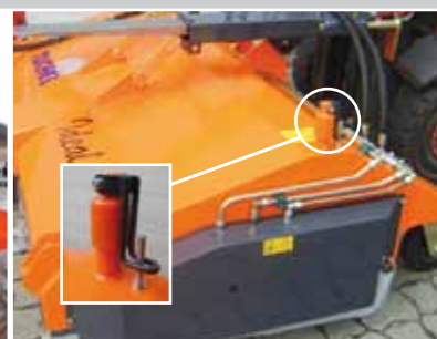
Handkurbel zum Einstellen der pendelnd aufgehängten Kehrwalze
