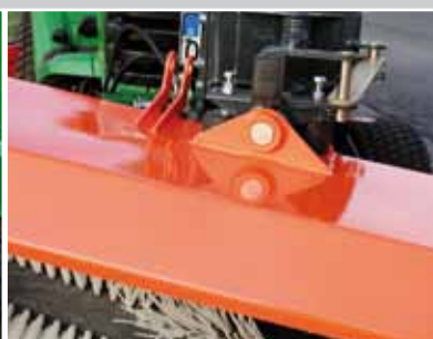
seitlicher Niveaue Ausgleich
