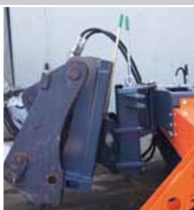
Rollenschacht mit Höhenanzeige und Pendeladapter
