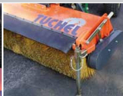
Rasthebelsystem und Abstellstütze
