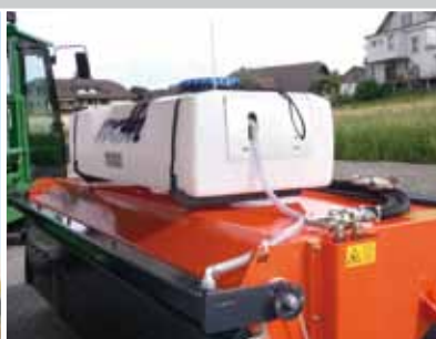
Wassersprüheinrichtung mit 100/200 Liter Wassertank
