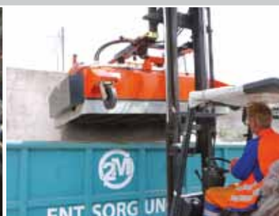
hydraulische Entleerung des Sammelbehälters, serienmäßig
