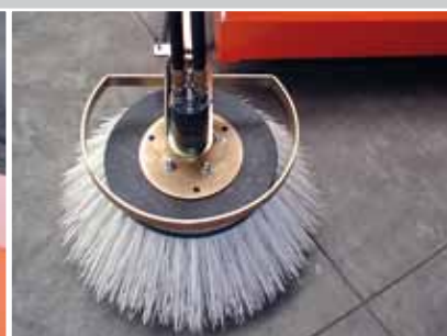
Seitenkehrbesen hydraulisch angetrieben
