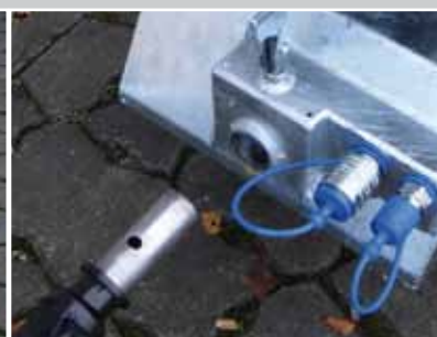
Schnellwechseleinrichtung u. doppelt wirkender Hydraulikanschluss serienmäßig
