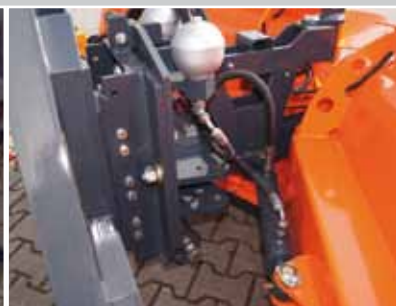
hydraulische Verstellung der Klappflügel
