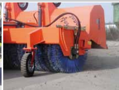
einfache Bürstennachstellung über Rasthebelsystem
