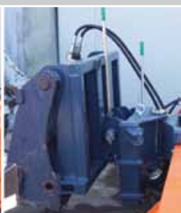
Rollenschacht mit Höhenanzeige und Pendeladapter
