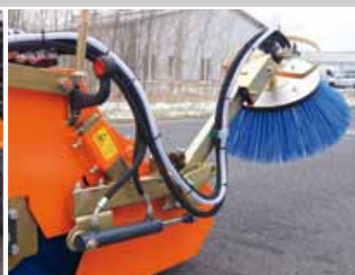
hydraulisch klappbarer Seitenkehrbesen
