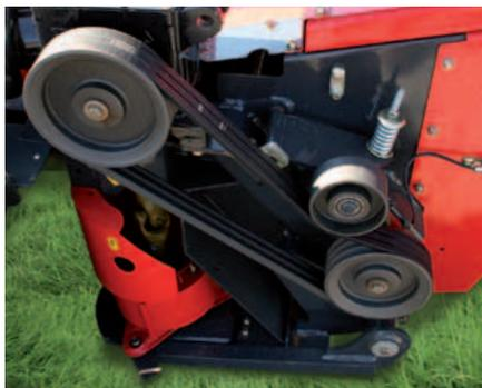
La cinghia di trasmissione trapezoidale del condizionatore con facile variazione della puleggia, permette di regolare la velocità del condizionatore da 600 a 900 giri/min.
