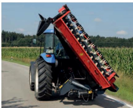
Le EXTRA 624T, 628T e 632T Farmer si chiudono verticalmente a 125° in posizione di trasporto tramite un cilindro idraulico.
