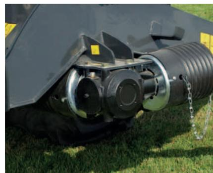
Variazione della velocità della scatola di trasmissione da 540 a 1000 giri/min.
