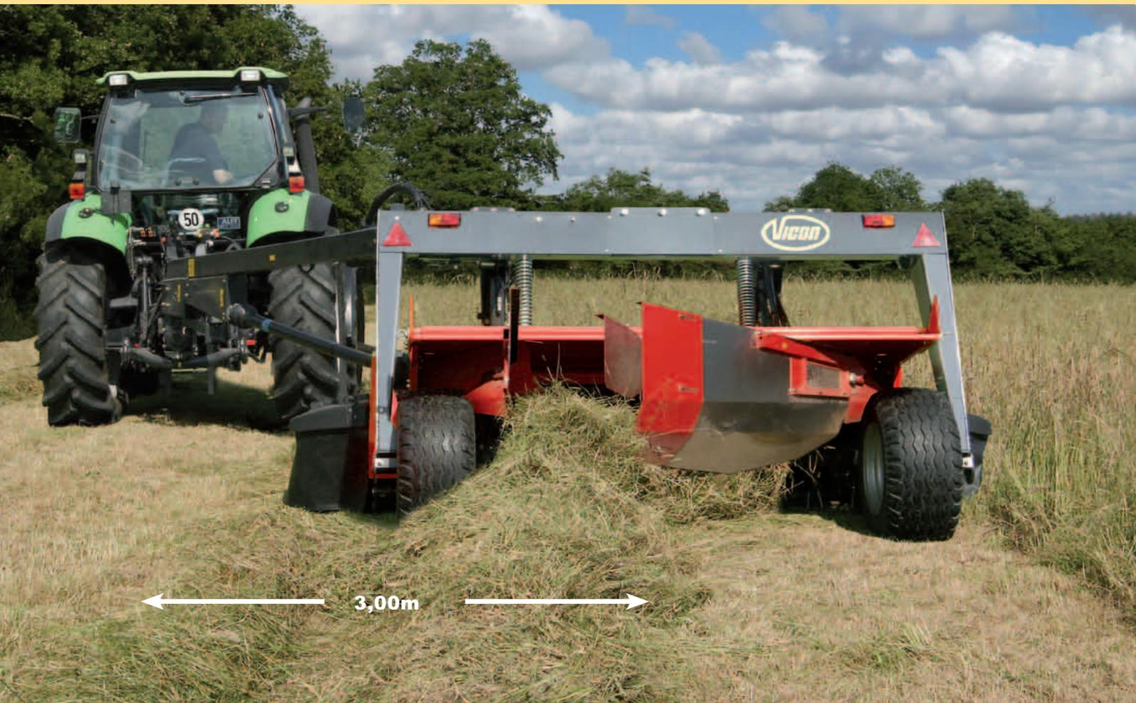
La falciatrice Vicon EXTRAΔ 832TD Pro è disponibile nella versione standard con raggruppatori d'andana azionati idraulicamente. I raggruppatori permettono all'operatore di raggruppare due andane vicine in una, aumentando la produttività per il successivo passaggio delle trince semoventi.
