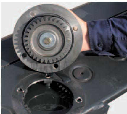
Ogni modulo (cuscinetto e ingranaggio) può essere rimosso individualmente per una facile e rapida sostituzione.
