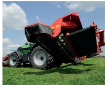
Nonostante le sue grandi dimensioni, con la EXTRAΔ 690T ISOBUS è facile eseguire le manovre in testata. Ogni unità viene sollevata indipendentemente tramite comando dalla centralina di controllo.
