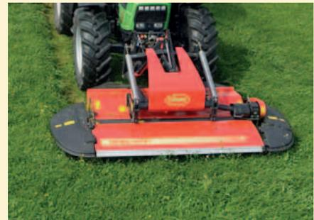
Permettono inoltre una escursione trasversale fino a 24°, assicurando un eccellente adattamento anche nei campi irregolari e una maggiore velocità di taglio.
