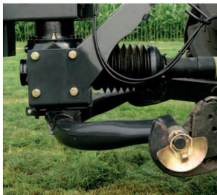
Testata d'attacco con scatola di trasmissione reversibile, per la massima capacità di manovra.
