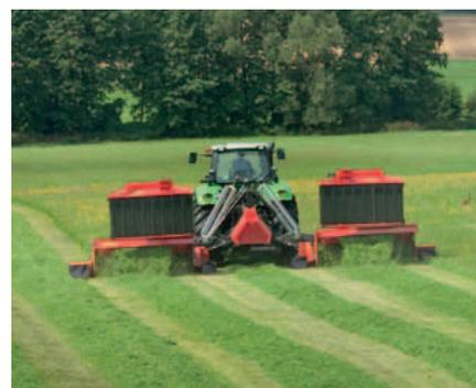
Quando non è in uso, il tappeto del raggruppatore d'andana Vicon viene sollevata idraulicamente al di sopra dell'unità di taglio, tramite control box in cabina.
