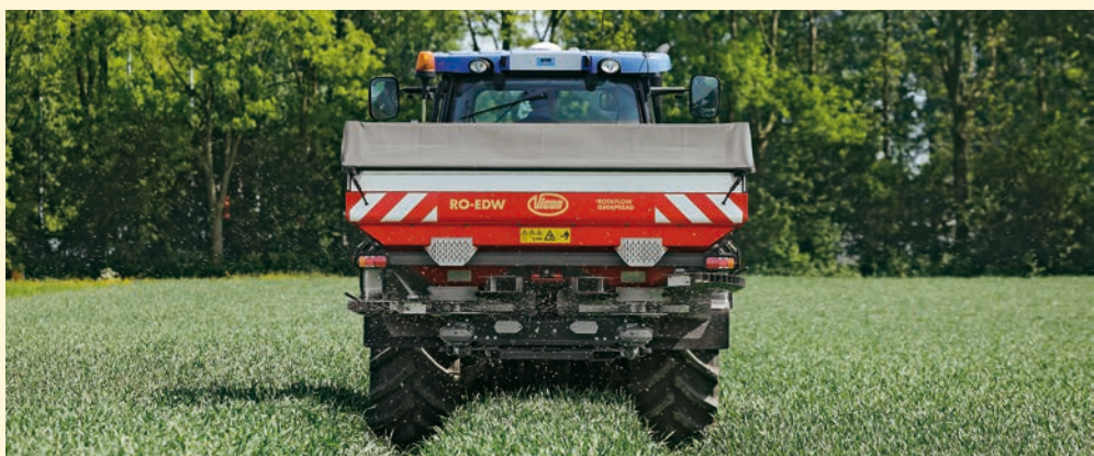
Spandimento di bordura con il sistema TrimFlow
