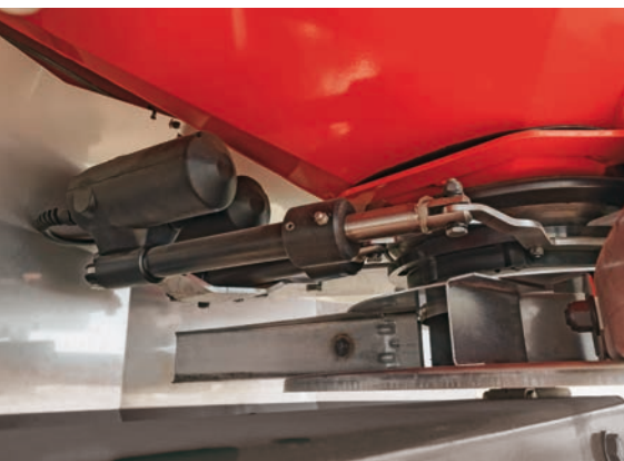
Due attuatori, posti su ciascuna unità di dosaggio, controllano il punto di scarico e il tasso di distribuzione.
