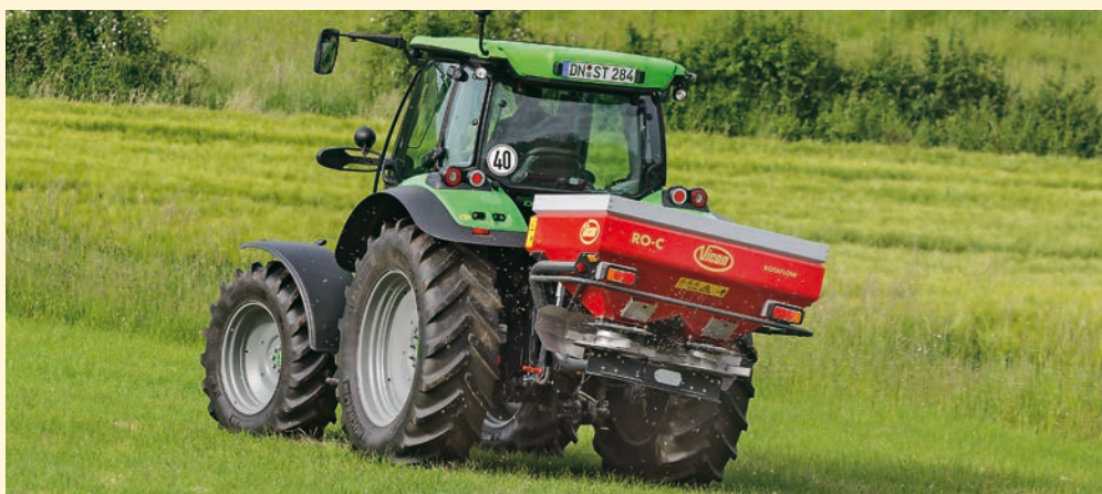
Spandimento di bordura dal tracciapassaggi
