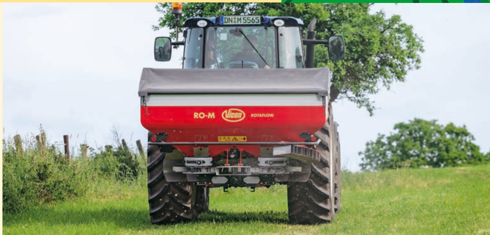
Spandimento di bordura tramite apposito carter
