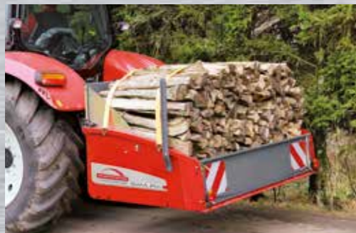
Ladesicherung: 6 definierte Befestigungspunkte für Zurrgurte zur Ladungssicherung
