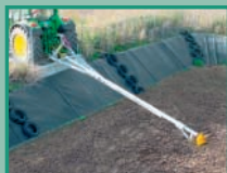
Miscelatore di liquame per vasche di liquame aperte e lagune
