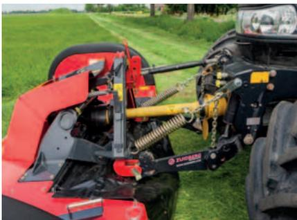
La struttura della testata d'attacco assicura un eccellente adattamento al terreno.
