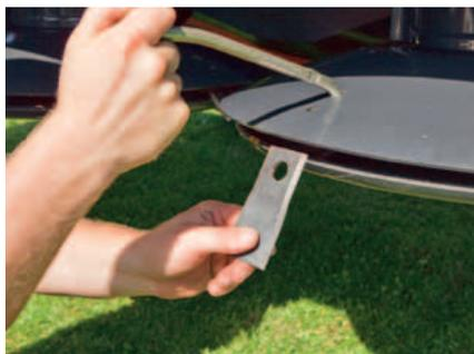
Coltelli facilmente sostituibili tramite una manovella. Basta premere verso il basso e i coltelli vengono rilasciati automaticamente.
