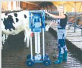
RECK-Spaltenbodenmischer für Schweine- und Rinderställe
