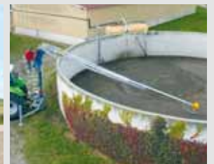
RECK-Zapfwellenmischer mit OZELOT Rahmenverlängerung für Güllehochbehälter. Hochbehälter-Zapfwellenmischer bzw. Turmmixer bis 6 m hohe Güllebehälter.
