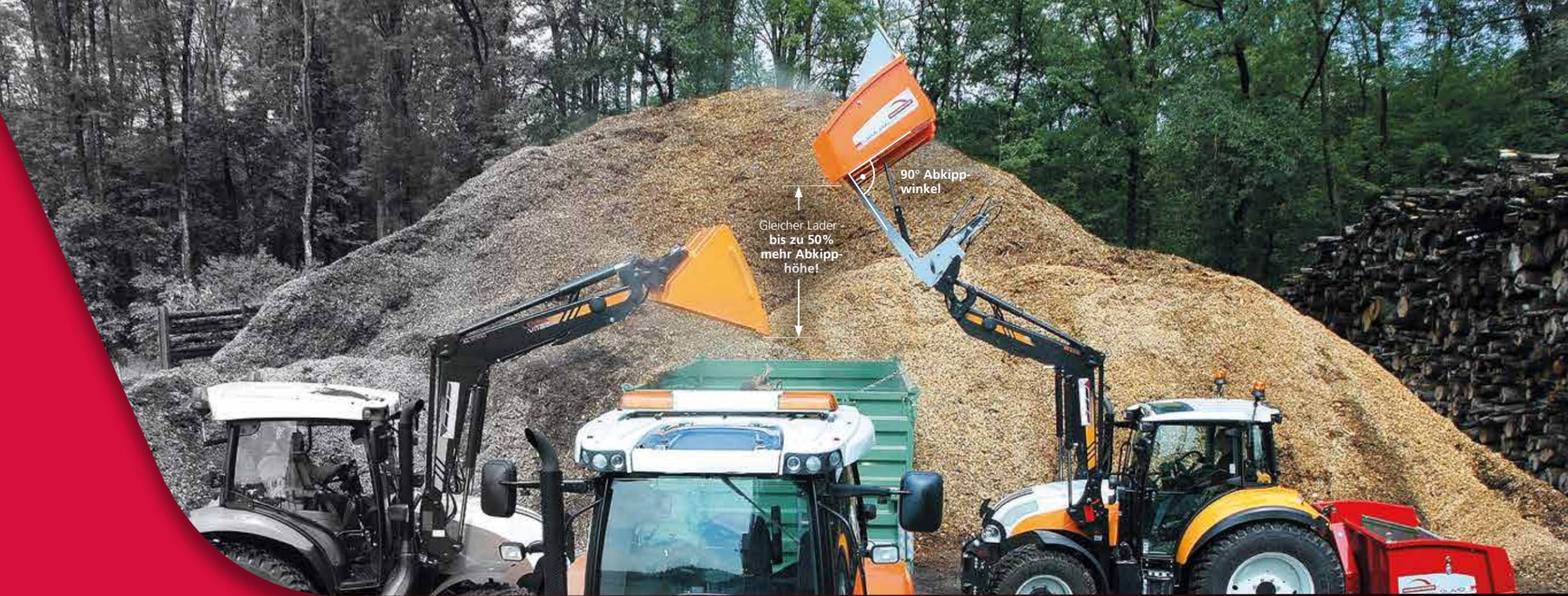
Laderschaufeln kippen an der Aufhängung nach unten. Im Gegensatz dazu sind Dreipunktlaster Hochkippschaufeln. Sie heben hinten an, über den Drehpunkt an der Vorderseite der Schaufel. Alleine dadurch ist deutlich mehr Abkipphöhe möglich.
