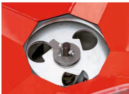
Um einen gleichmäßigen Durchfluss auch bei geringsten Ausbringmengen zu ermöglichen, ist der RotaFlow mit einem Feindosiersatz ausgerüstet. Ideal zum Streuen geringer Mengen, Saatgut und Schneckenkorn.
