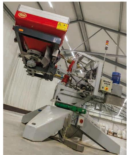
Dieses erlaubt einen schnellen Test verschiedener Düngemittel, aber ebenso zum erhöhten Schutz unserer Umwelt, weniger Dünger und verbesserte Qualität zu verwenden. Die 60,00 m lange Testhalle, mit Fußbodenheizung, hält die Luftfeuchtigkeit auf 60 %, wodurch das ganze Jahr Tests und Verteiltests mit Arbeitsbreiten über 54,00 m durchgeführt werden können.
