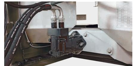
Hydraulischer Antrieb (optional für RO-XL/RO-EDW/RO-EDW GEOspread)
