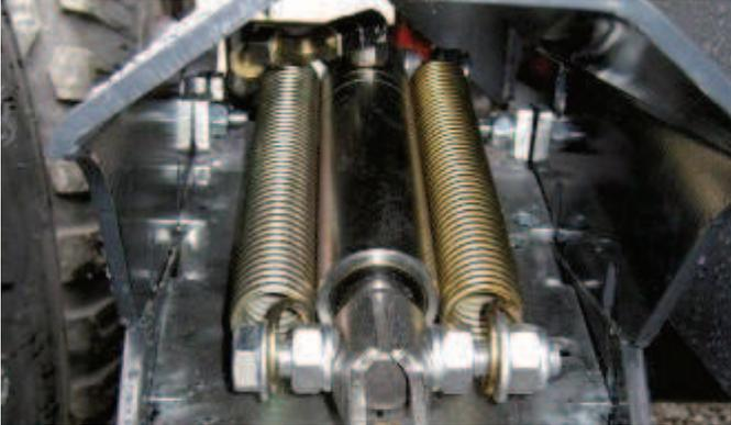
Hydraulische Bremse mit einem großen Zylinder an jeder Achse für eine kontrollierte Ansteuerung inkl. Rückholfeder. Komplette Schutzhaube
