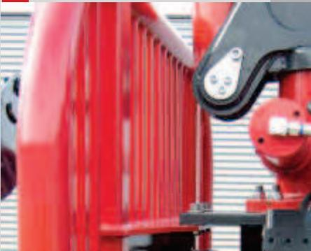
Schutzgitter zum Kran hin abgestützt
