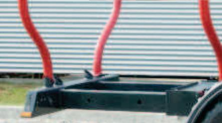
Zusätzliches Rungenpaar für 1 m Holz und Bündelladung Wagen teleskopierbar (450/900 mm) mit einfachem Federriegel
