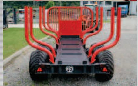
Bodenblech sowie Zusatz-Rungenhalterung für 1 m Holz bei jedem BEHA-Trailer serienmäßig
