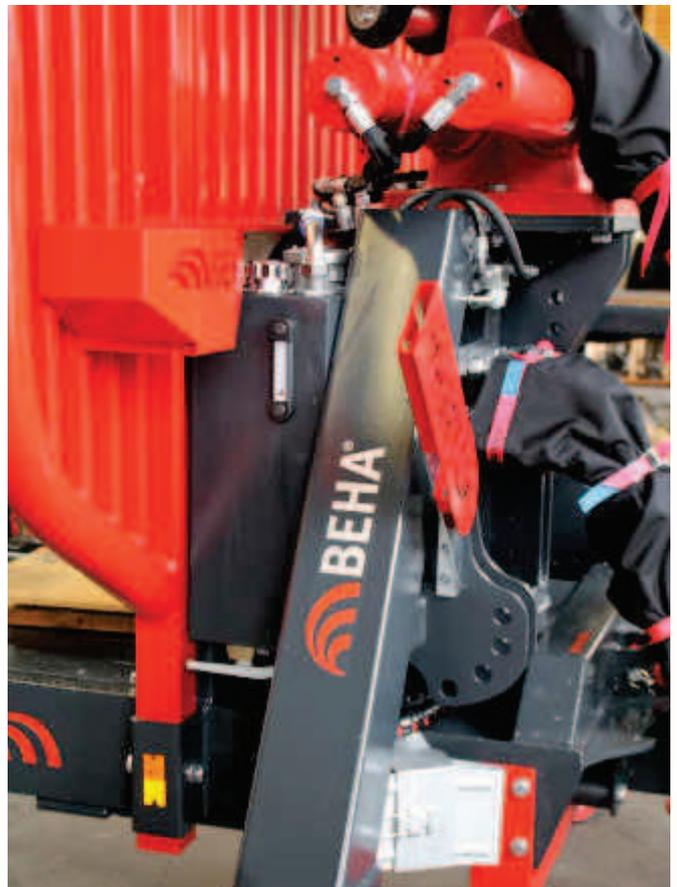
Hydrauliktank von eigener Ölversorgung zwischen A-Stativ und Prallgitter
