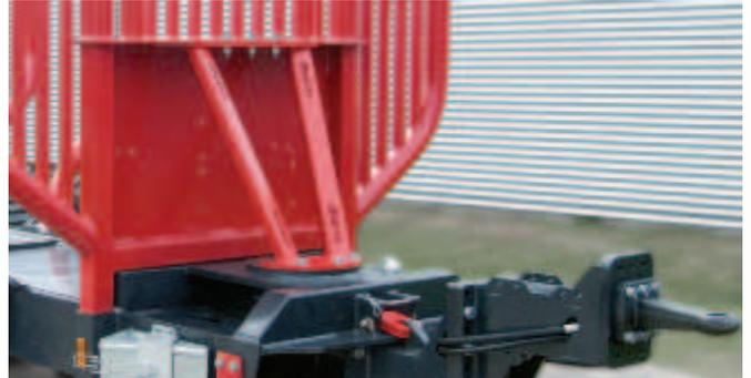
Prallgitterverstärkung wenn der Wagen mit dem Traktorkran beladen wird.
