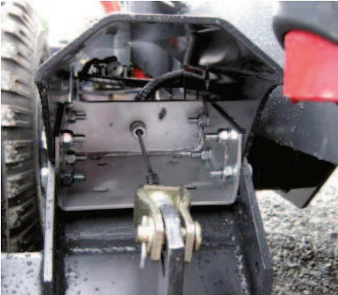
Hier zählt sich unser Baukastensystem aus: Einschraubblech und schon kann die Auflaufbremse angeschlossen werden
