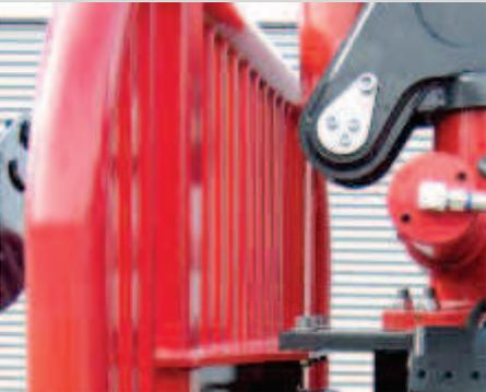
Schutzgitter zum Kran hin abgestützt
