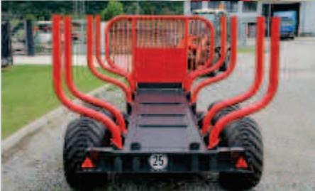
Zusatz-Rungenhalterung zum Beladen von 1 m Holz quer Bodenblech mit Rahmenseitenkante
