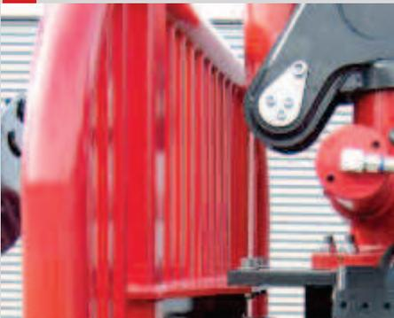
Schutzgitter zum Kran hin abgestützt
