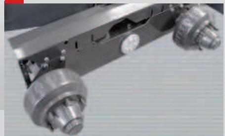
Durch eine ungleichmäßige Lagerung der Achsträger erreichen wir ein verbessertes Bremsverhalten der Hinterachse
