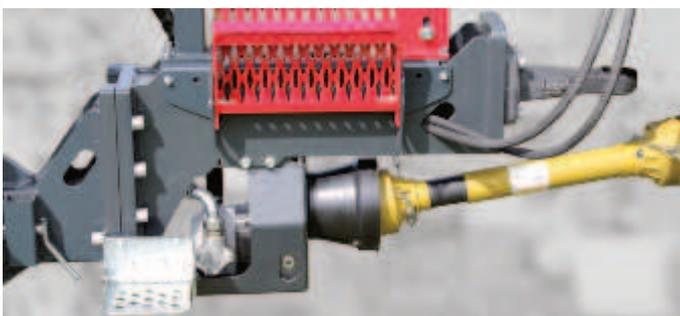
Eingebaute Pumpe an der Deichsel
