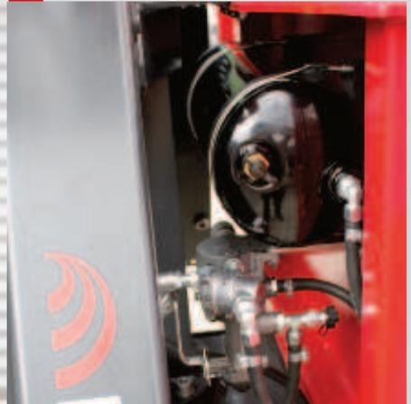
Druckluftanlage kann bei jedem BEHA-Trailer sauber zwischen A-Stativ und Prallgitter eingebaut werden
