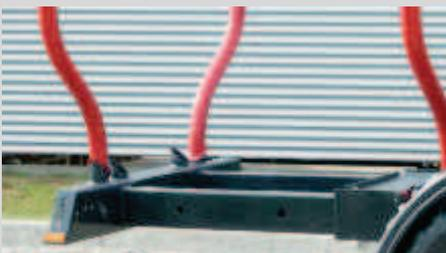
Zusätzliches Rungenpaar für 1 m Holz und Bündelladung
