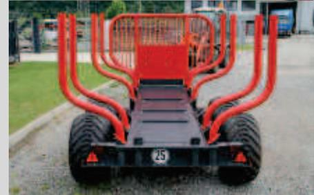
Bodenblech sowie Zusatz-Rungenhalterung für 1 m Holz bei jedem BEHA-Trailer serienmäßig
