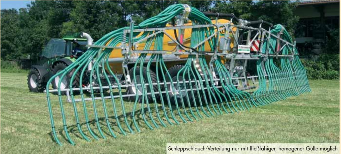
Schleppschlauch-Verteilung nur mit fließfähiger, homogener Gülle möglich
