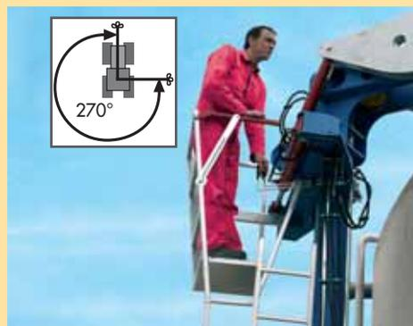
Rührstange hydraulisch drehbar bis 270°, Rührturm hydraulisch teleskopierbar bis auf 6 m
