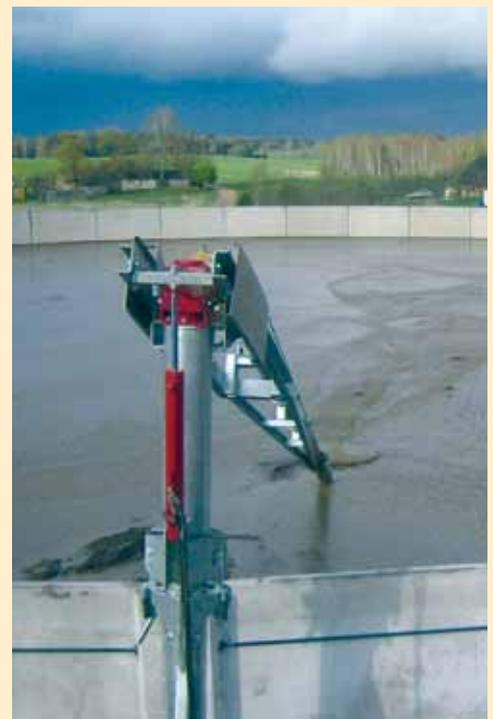
Restloses Homogenisieren von Schwimm- und Sinkschichten
