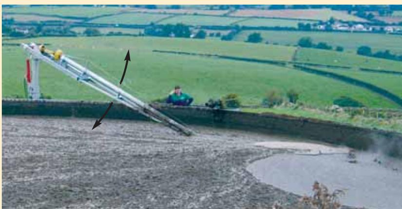
Vollständiges Homogenisieren in einem Behälter bis 44 m Behälterdurchmesser.
