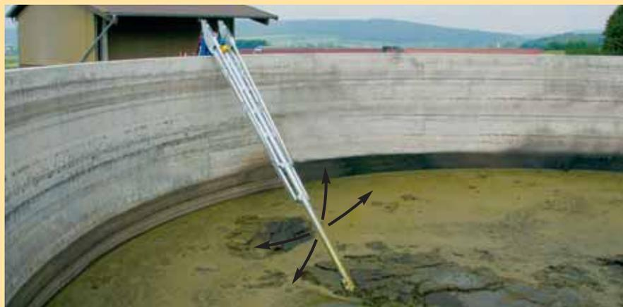
RECK Zapfwellen-Turmmixer **MAMMUT-TITAN** mit schwenkbarer Rührstange im Einsatz
