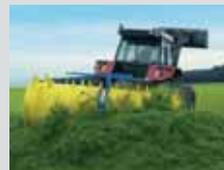
Grassilageverteiler für Flachsilos oder Silos mit Seitenwänden
