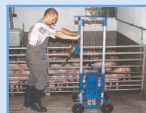
Miscelatore per pavimento grigliato di maiali
