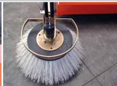
Seitenkehrbesen hydraulisch angetrieben
