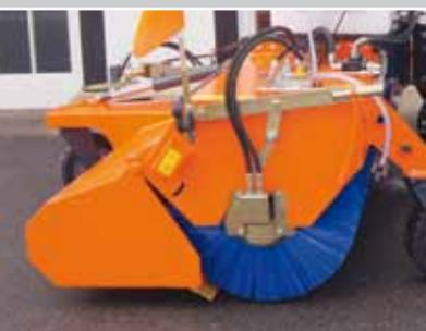
innenliegender Motor und Kehr-Keil-Optimierung
