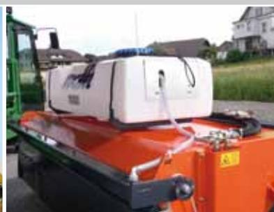
Wassersprüheinrichtung mit 100/200 Liter Wassertank
