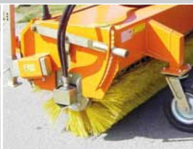
zwei leistungsstarke, innenliegende Motoren für den Bürsteantrieb
