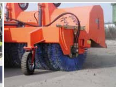
einfache Bürstennachstellung über Rasthebelsystem
