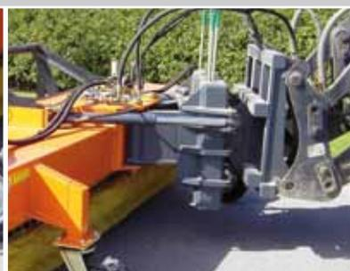
optimale Boden Anpassung durch robusten 3D-Niveaueingleich
