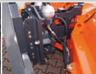
hydraulische Verstellung der Klappflügel
