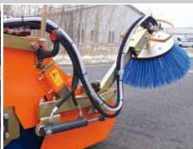
hydraulisch klappbarer Seitenkehrbesen
