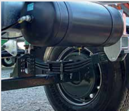
Achsaggregat mit Parabelfederung für optimale Laufruhe.
