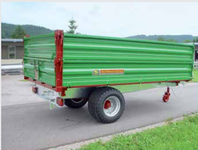
SCHWAIGHOFER Einachs-Dreiseitenkipper, Type ED 9,0 t Gesamtgewicht mit 4-stufigem Kippzylinder.
