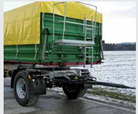
Y-Zugdeichsel und Lenkkranz in LKW-Ausführung serienmäßig.
