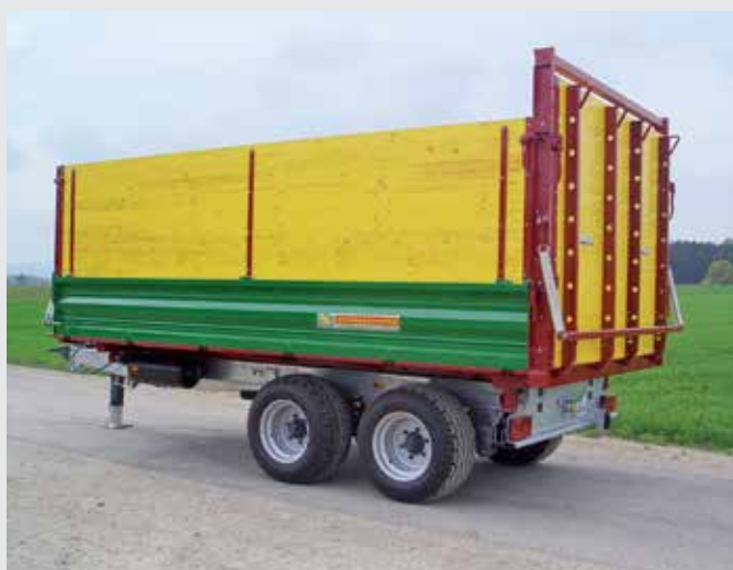
Aufbauten für Vieh- und Leichtguttransport mit seitlichen Eckstehern und rückwärtiger Viehtreppe.
