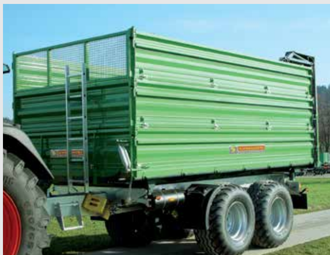
Aufbauten für Vieh- und Leichtguttransport mit seitlichen Eckstehern und rückwärtiger Viehtreppe.
