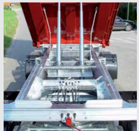
Eine geschlossene Parallelrahmenkonstruktion gewährleistet höchste Stabilität und Steifigkeit in jedem Einsatzbereich.
