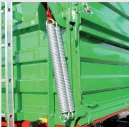
Weiters bieten Ihnen sechs selbstspannende Bordwandverschlüsse (seitlich und rückwärts) Sicherheit und Bedienungskomfort.
