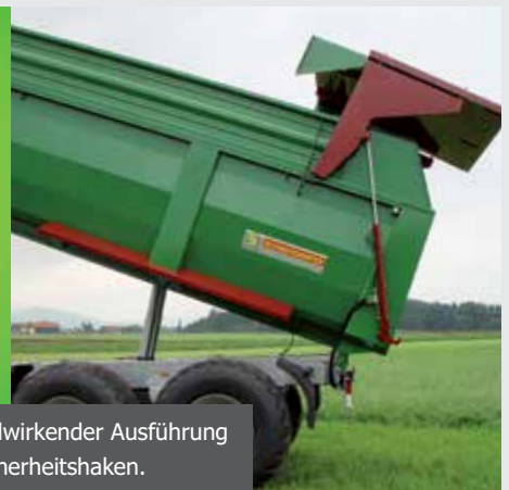
Die konische Wanne erleichtert das Abrutschen der Ladung.
