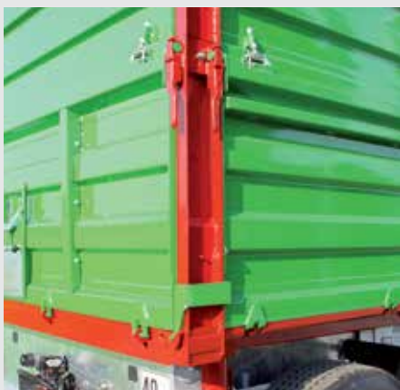
Verschraubte Ecksteher rückwärts in verstärkter Ausführung sind das Markenzeichen der SCHWAIGHOFER-Kipperserie.
