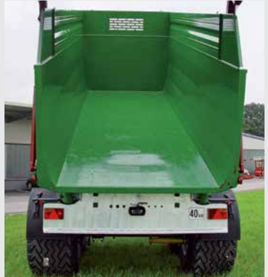
Die konische Wanne erleichtert das Abrutschen der Ladung.
