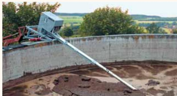
Il fissaggio al caricatore frontale è adatto quando l'agitatore viene utilizzato con un trattore con il sollevatore frontale o con una pala gommata.
