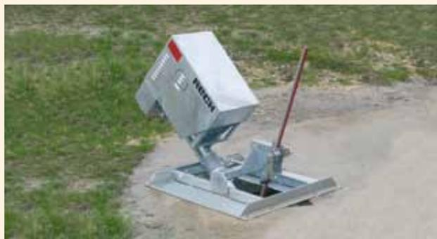
ETR con Fissaggio per vasche di stoccaggio liquami coperte. La regolazione dell'inclinazione avviene attraverso una barra dentata.
