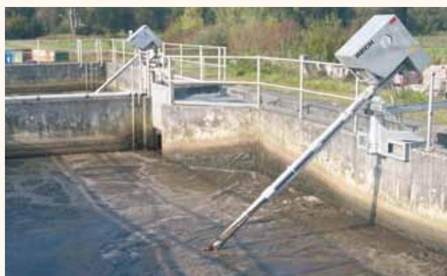
Agitatore elettrico con fissaggio stazionario per vasche di stoccaggio liquami aperte (cod.: ETR-HS)
