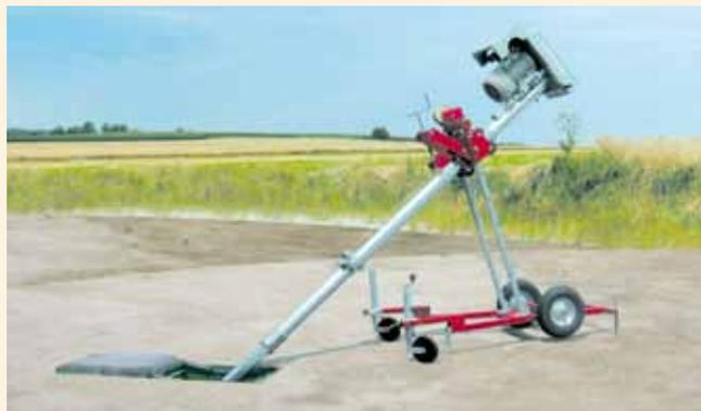
**Mod. ETR** - Agitatore elettrico maneggevole, con manovella per la regolazione dell'inclinazione. Per aperture del serbatoio da **60 cm ø**. Utilizzabile con agitatori lunghi fino a **5,0 m**. e con una forza fino a **11,0 kW (15,0 CV)**
