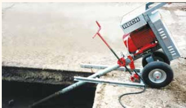
Agitatore elettrico RECK per canali **FUX** con fissaggio di sostegno e di regolazione in altezza (Cod.: EK-NB)
