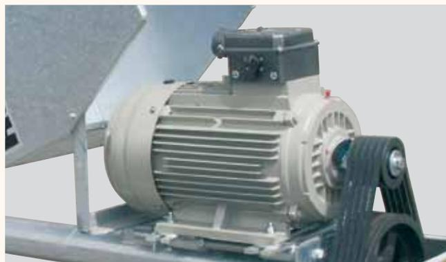
Impianto di trazione a cinghie trapezoidali, di facile manutenzione
