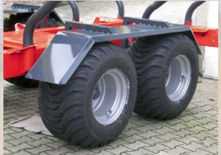
Mit **Zulassung für 40 km/h** und **Kotflügel**
