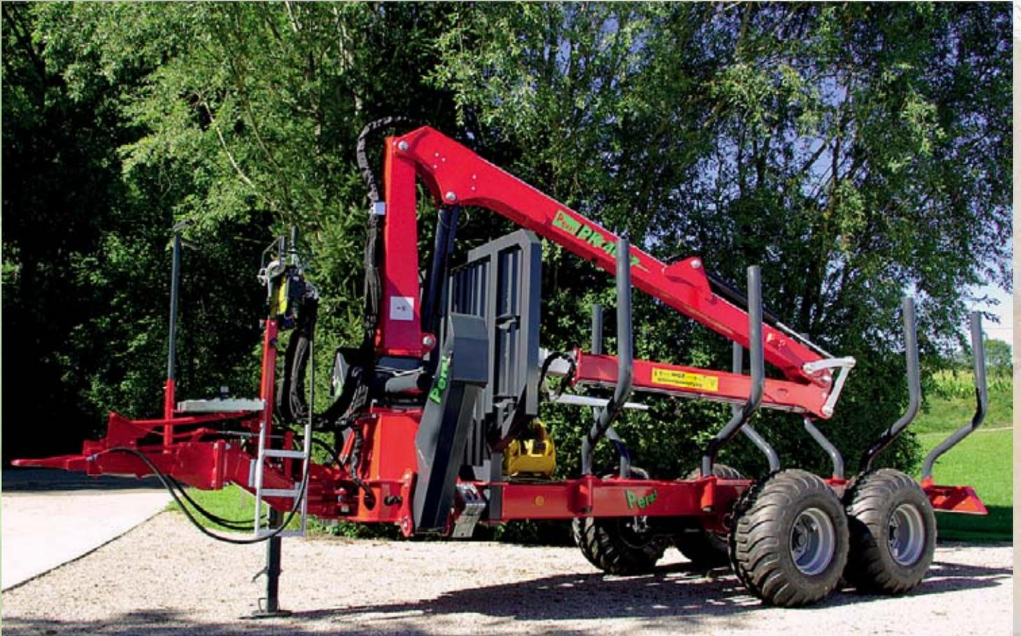
**PRW 8 t** mit Stehpodest, Auflaufbremse und Pumpe (Bordhydraulik)
