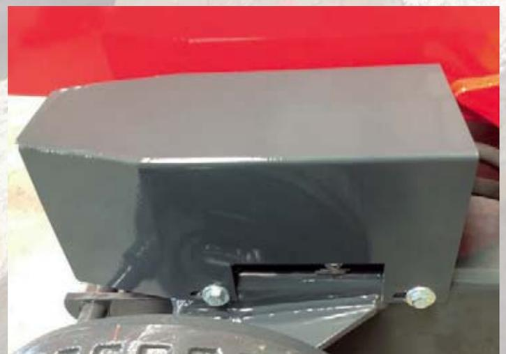
**Schutzabdeckung** für Druckluftzylinder auf der Bogeachse
