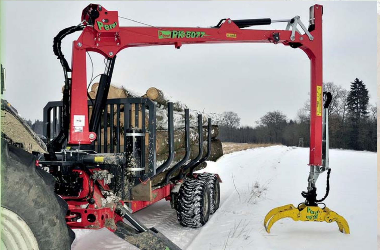
12 t Rückewagen, Kran Typ PK 5078 mit aufgebauter Winde. Verkürzter Ausleger, 500er-Bereifung
