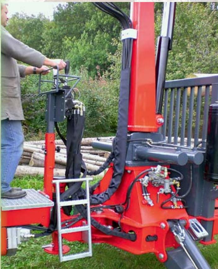
Der sichere **Bedienerstand** auf der Deichsel bietet eine optimale Übersicht beim Be- und Entladen
