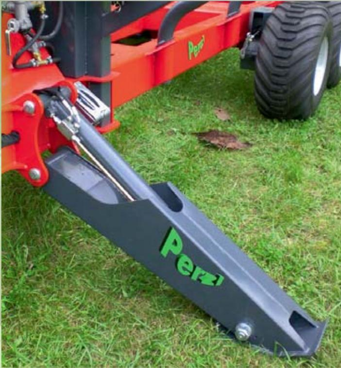
Die **klappbare Abstützung** mit geschützter Kolbenstange erreicht eine sehr hohe Sicherheit beim Beladen (Standweite 3.200 mm)
