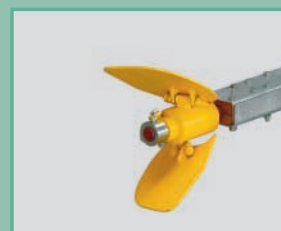
2-flügliger Faltpropeller (für Öffnungen ab 250 mm, nur drückend erhältlich, aufgeklappt 500 mm \varnothing )
