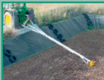
Güllemixer für offene Güllegruben und -lagunen
